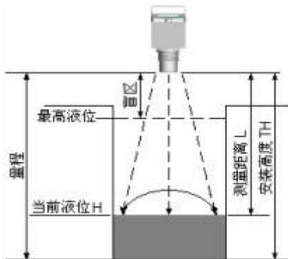
如上图所示，仪表的探头发波打到液位后反射回探头，探头接收到后计算发波到收波的时间，得到测量距离  $L$ ，仪表安装高度  $TH$  减去测量距离  $L$  将得到当前液位  $H$ 。
